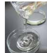
透明ポリイミドワニス「ネオプリム®」は無色透明性と300°C以上の耐熱性を活かし、スマートフォン部材等の情報通信分野での採用が進んでいます。
